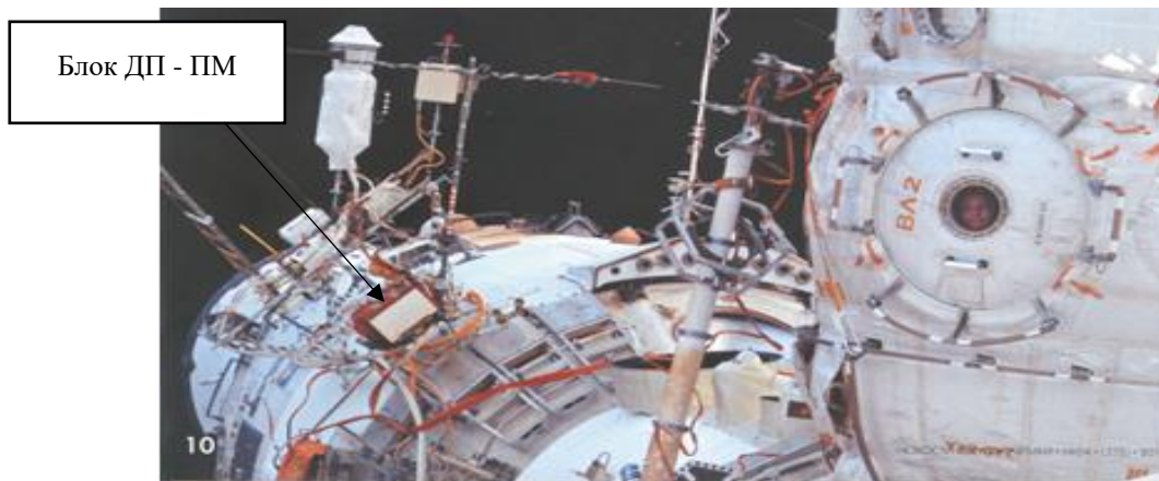
Фиг. 31. Монтираният блок ДП - ПМ, ПВК1 върху повърхността на МКС - реална снимка направена на орбита
